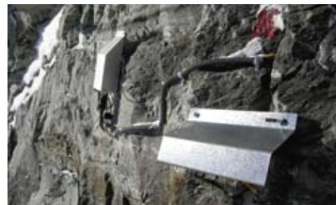
Gut gegen die Elemente geschützt, messen die Sensoren am Matterhorn Temperaturprofile und Bewegungen.
